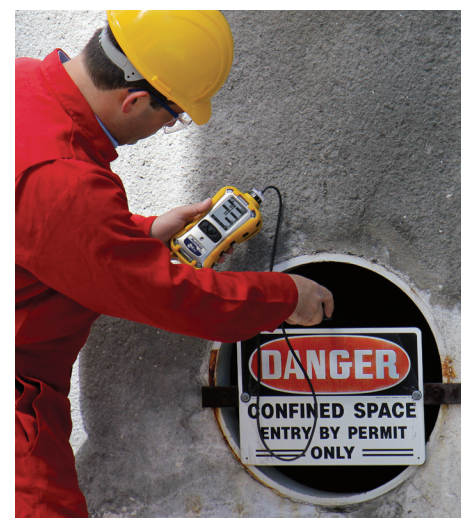
Testen geschlossener Räume mit dem MultiRAE Lite
